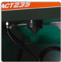
Atomizador de sistema Venturi
