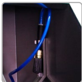
Brocha con agua para limpieza exterior.
