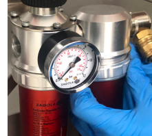
Fetten Sie das Gewinde ein und schließen Sie den Behälter
