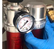
Graissez le filetage et fermez le réservoir
