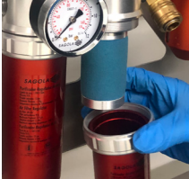
Desmonte o depósito
