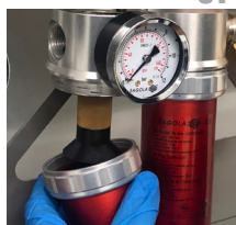
Desmonte o depósito
